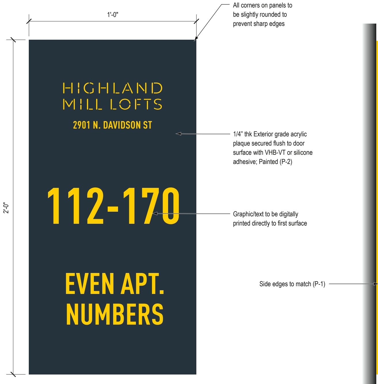
2 Detail Elevation Scale: 3" = 1'-0"
