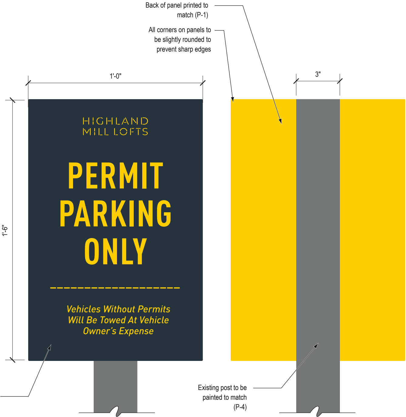
2 Front Elevation Scale: 3" = 1'-0"
